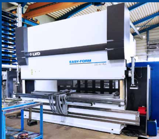
LVD Easy Form 9 220/42 Plus CNC-hydraulische Abkantpresse Presse plieuse hydraulique à commande CNC
