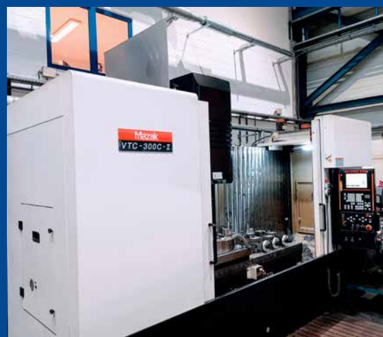
MAZAK VTC-300C-II Vertikales Bearbeitungszentrum: „Zweitisch-Anlage“ für Pendelbearbeitung Centre d'usinage vertical : « installation à deux tables » pour l'usinage pendulaire
