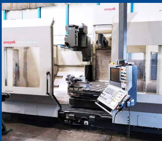
CORREA ANAYAK VH-PLUS-3000 MG9 – 5-Achs Bearbeitungsmaschine mit integriertem Drehtisch Machine d'usinage à table tournante intégrée
